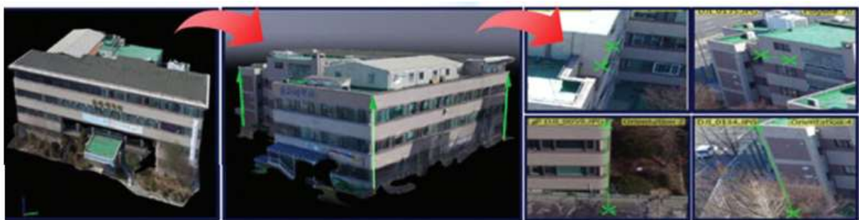
[건축물 안전진단(모델링 및 보정작업(왼쪽, 가운데), 건물 기울기 및 각종 균열 측정(오른쪽))]
