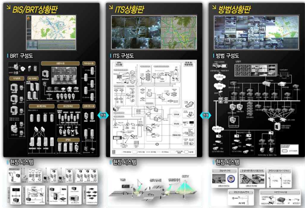
〈그림 II-44〉 스마트도시통합센터 시스템 구성도 ①
