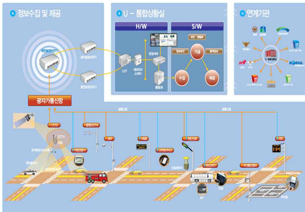
〈그림 II-45〉 스마트도시통합센터 시스템 구성도 ②
