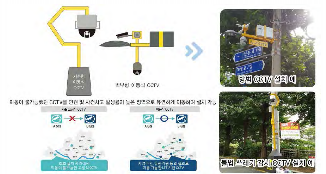
[그림 IV-46] LTE 기반 이동형 CCTV 구성도
