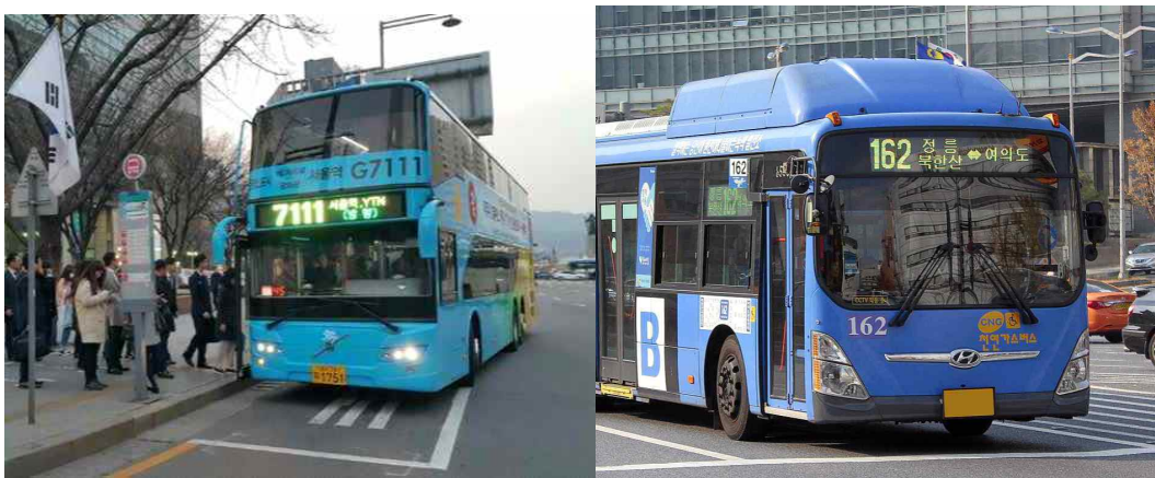
[그림 5-7] 버스 번호 및 행선지 시인성 개선 예시
