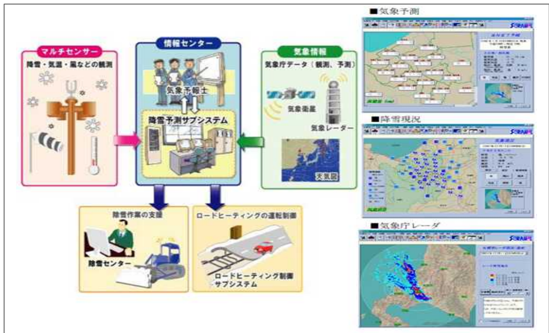
[그림 5-2-16] 삿포로시 겨울 도로교통 정보 시스템의 구조
