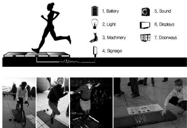
[그림 5. 2-25] Powerleap에서 개발한 발전기 개념도 및 발전기를 이용한 발전
