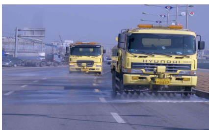
시책그림 7. 고압 살수차량을 이용한 도로물청소 장면
