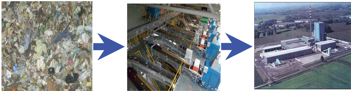
그림 108. 가연성 폐기물의 에너지화 과정(폐자원, 파쇄·선별, 연소 및 에너지 생산)
