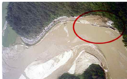
하천 세굴에 의한 도로 붕괴(2)
