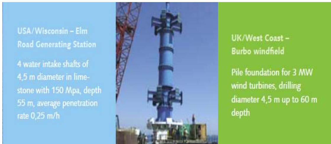
<그림 V-27> Wirth 사의 초대구경 RCD 시공실적 및 사진
