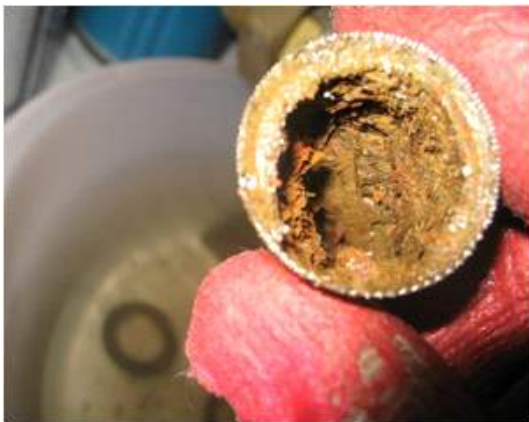
이물질로 막힌 세대내부 싱크대 안에 설치된 여과필터의 상태
