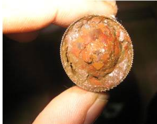
이물질로 막힌 세대내부 싱크대 안에 설치된 여과필터의 상태
