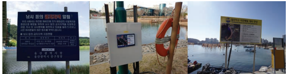
통일성 부족과 색채의 잘못된 사용 및 지나치게 작은 크기로 인지성과 시인성이 결여된 안전, 주의표지
