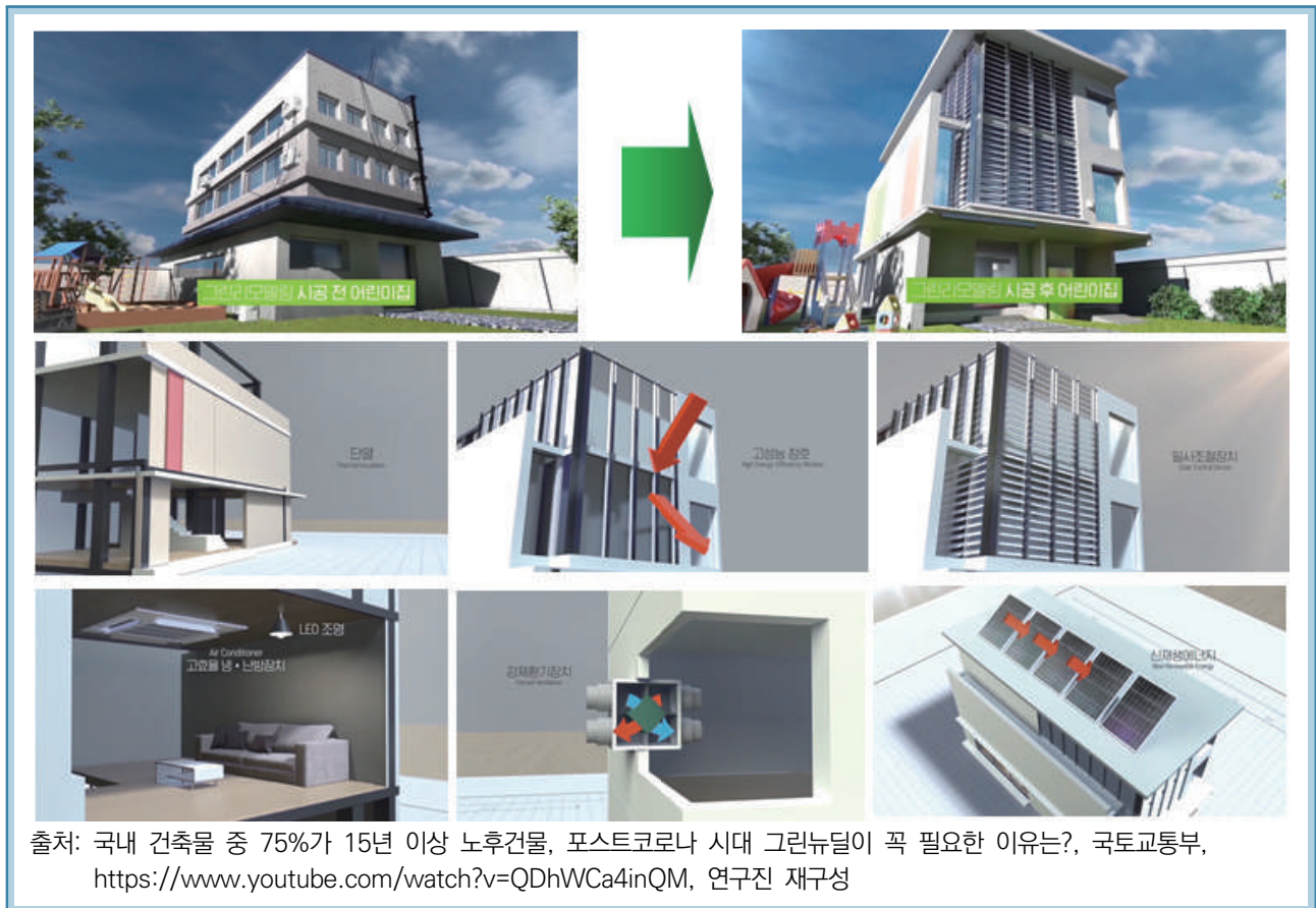
〈그림 80〉 공공어린이집 그린리모델링 사례: 단열, 고성능창호, 일사조절장치, 고효율조명, 고효율냉난방장치, 강제환기장치, 신재생에너지
