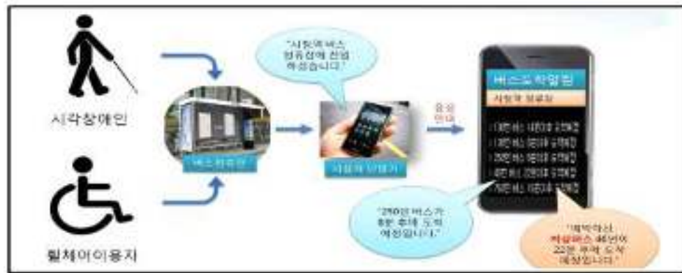
<그림 V-24> 무장애정류소 내 시각장애인을 위한 음성안내시스템
