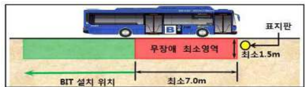
&lt;그림 V-23&gt; 독립형버스안내단말기(BIT) 설치 위치
