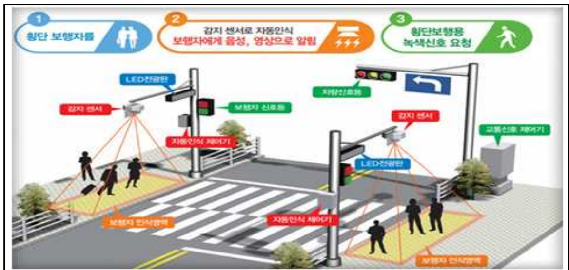
[ 그림 5-40 ] 보행자 자동인식 신호 개요도
