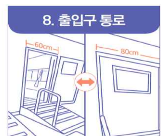
이동통로 유효폭 확보 및 손잡이(점자테이프 포함) 설치
