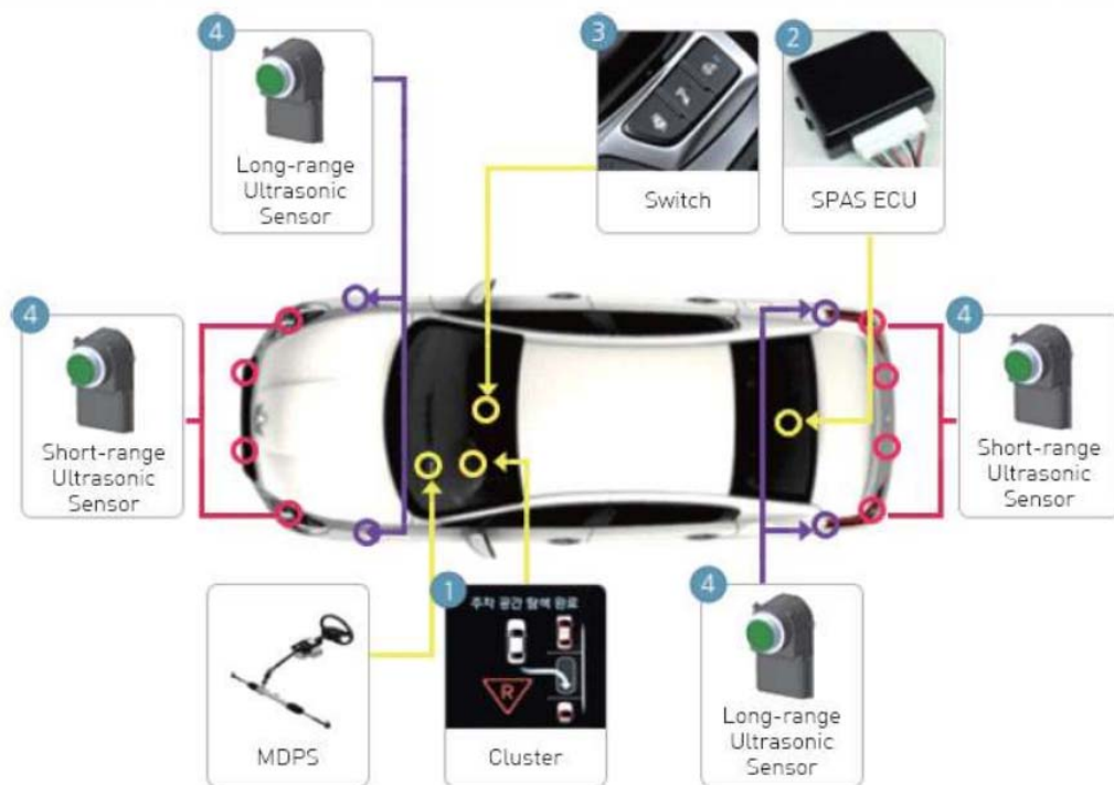
[그림 1-2-63] 주차 보조 시스템의 핵심 구성요소
