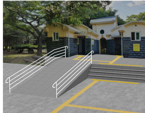
[그림 6-57] 신산공원 화장실2 경사로 및 계단 개선
