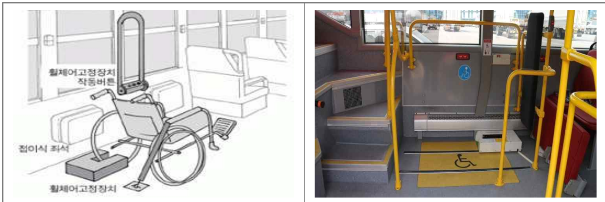
(그림 5-51) 저상버스 차량내 휠체어 고정장치 시설 적정 설치사례
