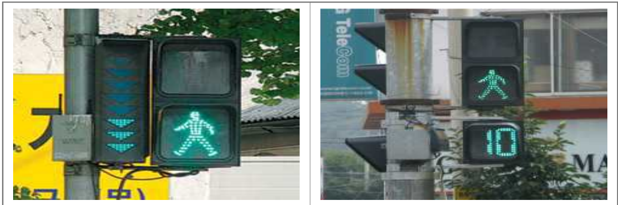
(그림 5-75) 횡단보도 잔여표시기 설치 사례
